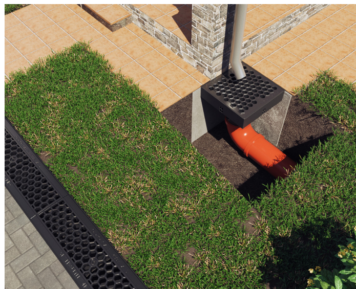
Использование ливнеприемника под трубой
